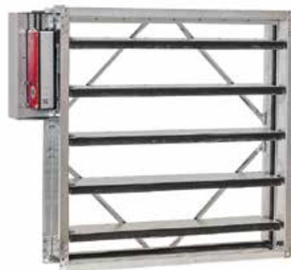
– **противопожарные нормально открытые клапаны** в системах общеобменной вентиляции, кондиционирования и воздушного отопления в целях предотвращения проникания в помещения продуктов горения (дыма) во время пожара, а также в приточных и вытяжных системах помещений, защищаемых установками газового, аэрозольного или порошкового пожаротушения (см. п.п. 6.10-6.12, 6.22 и 7.13 СП 7.13130.2013);
