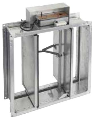
**Клапан дымовой:** Клапан противопожарный, нормально закрытый, имеющий предельное состояние по огнестойкости, характеризующееся только потерей плотности, и подлежащий установке непосредственно в проемах дымовых вытяжных шахт в защищаемых коридорах и холлах.
