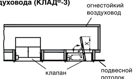
Рекомендуемые размеры монтажного проема:  $L=A+10...20$  мм;  $H=B+10...20$  мм. При невозможности обеспечения увеличенных размеров проема для установки «стеновых» клапанов (например, в случае их монтажа в проем воздуховода) рекомендуется заказывать клапаны с установочными размерами А и В, уменьшенными на 10-20 мм.
