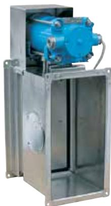
Противопожарные нормально закрытые клапаны КЛОП®-2(60/90/120) и нормально открытые клапаны КЛОП®-2(90/120) для районов с морским климатом и помещений с повышенной влажностью изготавливаются из нержавеющей стали. Электропривод с возвратной пружиной или реверсивный электропривод помещен в оболочку, имеющую степень защиты IP 66. **Корпус клапанов выполняется прямоугольного сечения.** Клеммная колодка установлена во вводной коробке оболочки.
